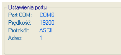
Rys.10 Parametry transmisji i adres slave
